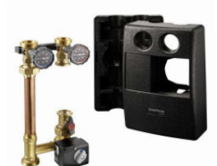
„Regumat M3-180“ Ду 32 с шаровым краном перед насосом с трехходовым смесителем и сервомотором 230 В
