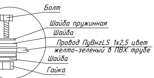
*Подключение к дополнительной системе уравнивания потенциалов металлических ванн и душевых поддонов*
