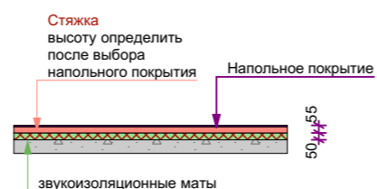
РАЗРЕЗ ПОЛА (ЗОНА КУХНИ-ГОСТИНОЙ)
