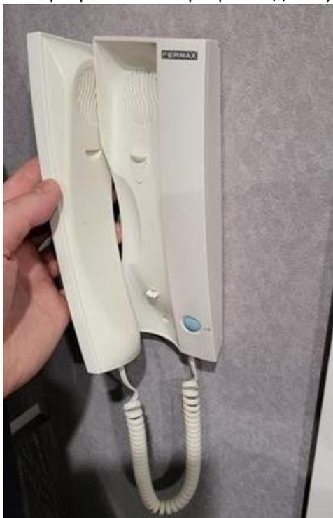
К трубке подходит многожильный УТР-кабель, 3 жилы которого используются трубкой, а остальные – резерв для видеодомофона:
