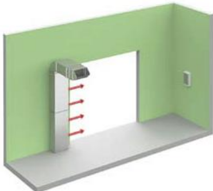
Вертикальное расположение 1 завесы с отводом нагнетающего блока назад*
