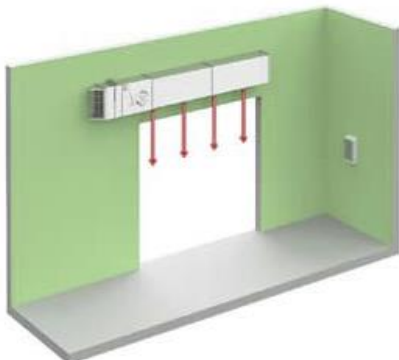
Вертикальное расположение 1 завесы с отводом нагнетающего блока назад*
