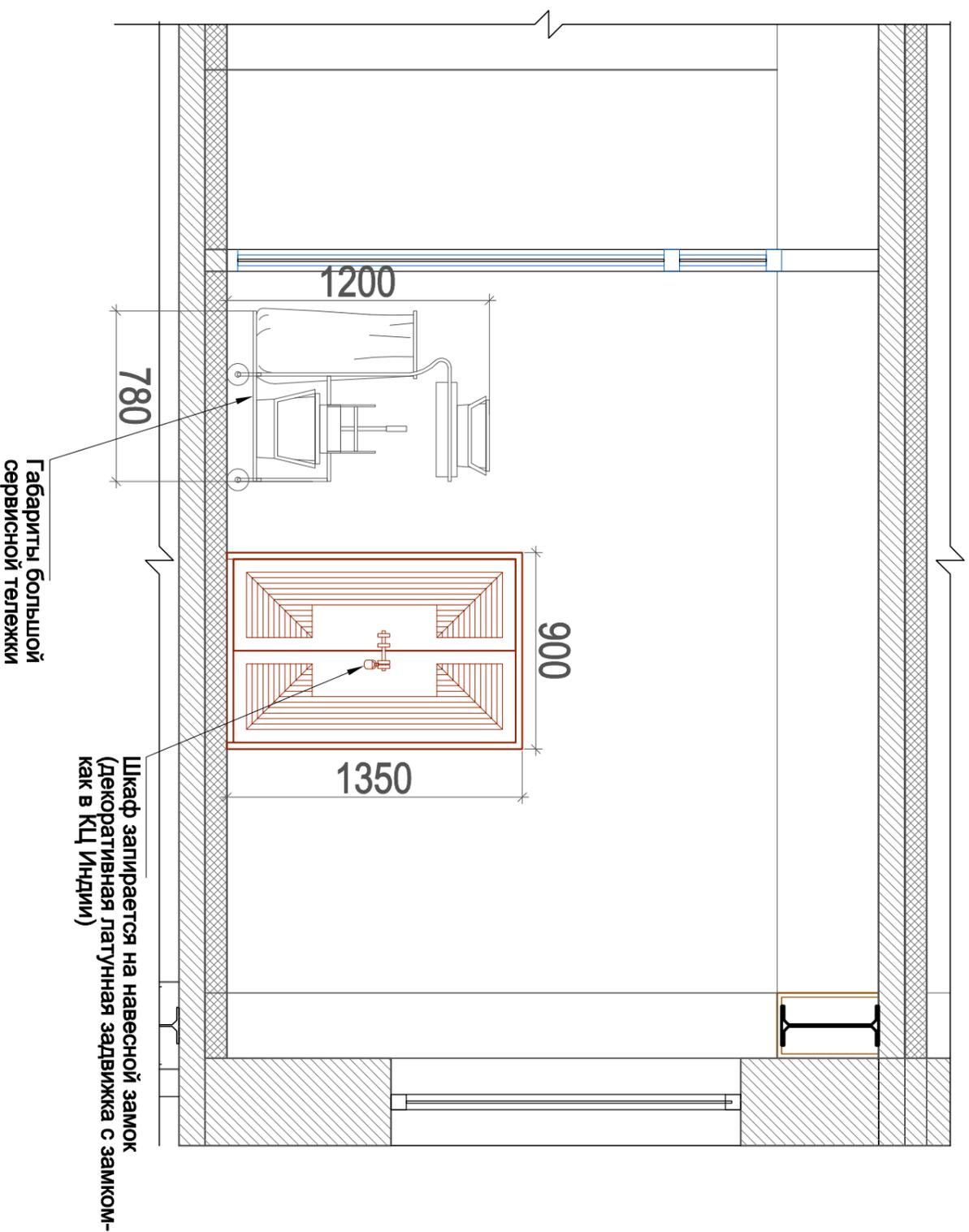
Внимание! Уточнить модели и габариты закупаемых тележек. В случае необходимости подкорректировать размеры шкафа в соответствии с габаритами тележек. Желательно уменьшить глубину шкафа, исходя из того, что обычная ширина тележки- около 60 см- для свободного прохода в дверной проём. Поэтому, глубину шкафа лучше откорректировать по ширине закупаемой тележки- сделать 65 см. внутри шкафа, тем самым сузить шкаф. Шкаф не должен иметь дна и порога для свободного закатывания тележки внутрь.
