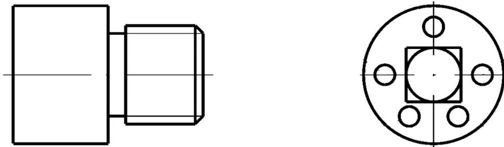
1. Диаметр отверстия - 2мм,
