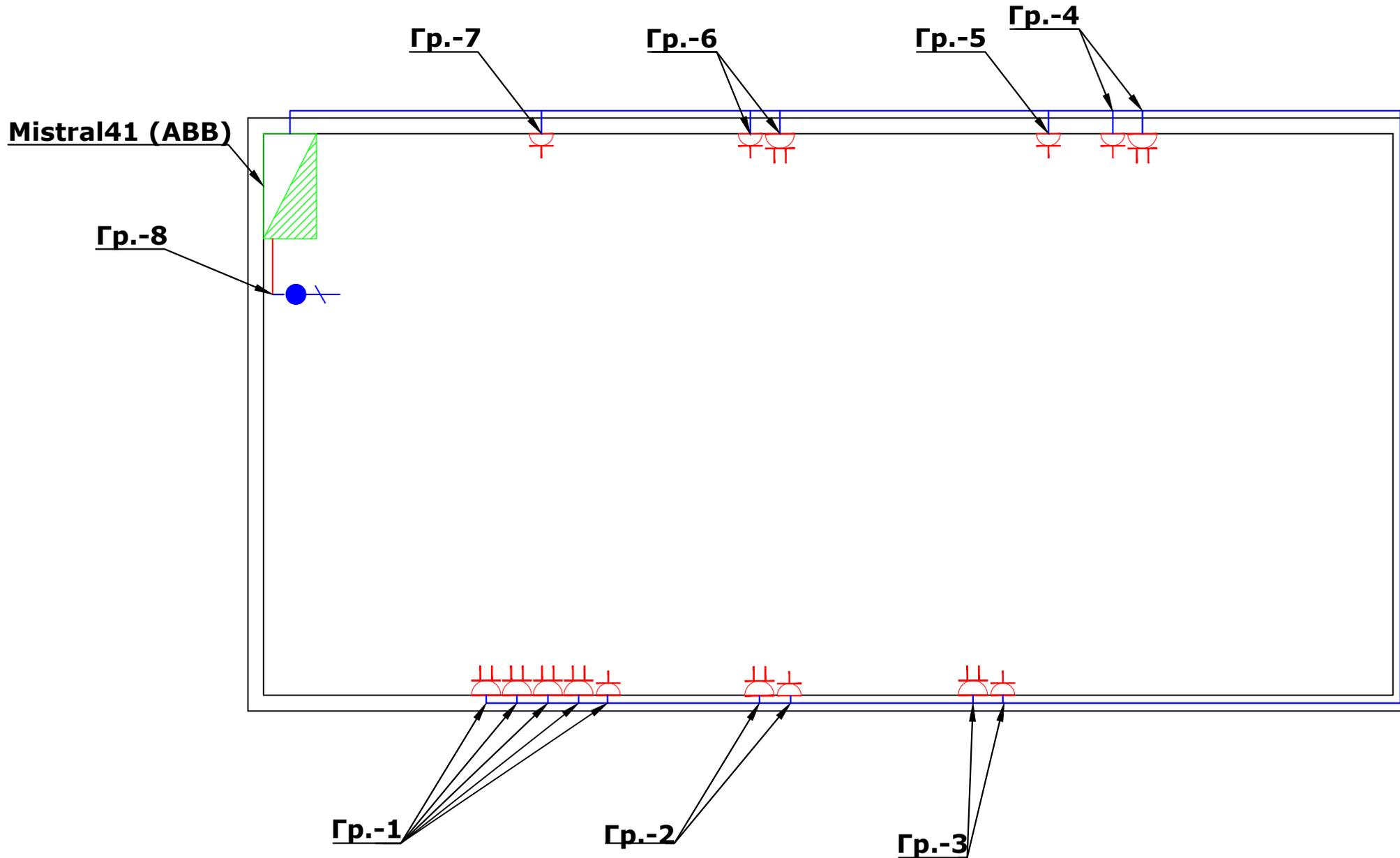
— -Кабель силовой ВВГнг-LS 3x2,5 в трубе ПВХ D=20mm
