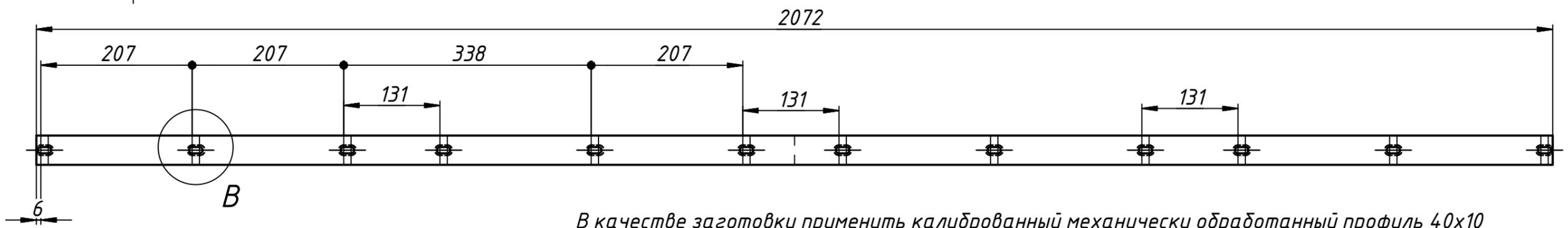
В качестве заготовки применить калиброванный механически обработанный профиль 40x10 Омутинского металлургического завода.
