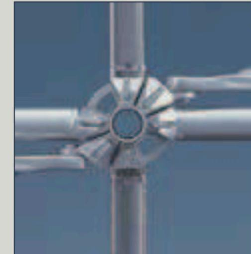
**В системе строительных лесов Layher Allround применяется простая и в то же время уникальная, технология безболтового клинового соединения.** Заведение клина в отверстие фланца моментально обеспечивает надежное крепление элемента. Закрепление другого конца элемента также не составляет большого труда – существует много способов его установки.
