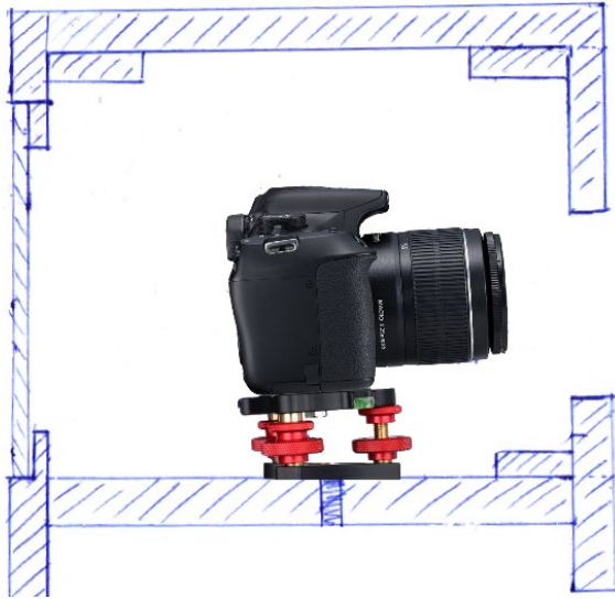
Рисунок 7. Расположение адаптера и фотоаппарата внутри сечения модуля
